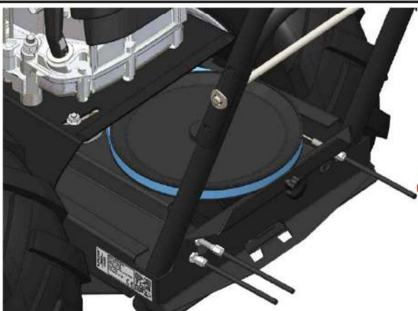
Obr. 11: Seřízení napínacích kladek pojezdu
